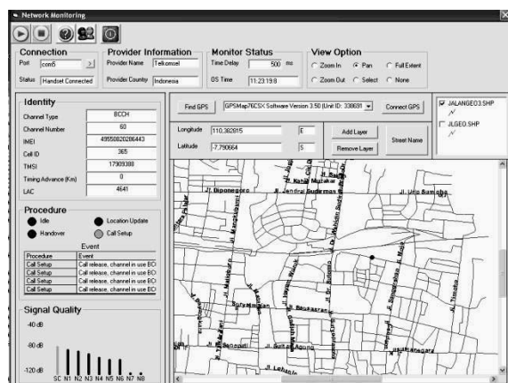
Gambar 9. Tampilan Program pada Saat Position Monitoring Dijalankan
