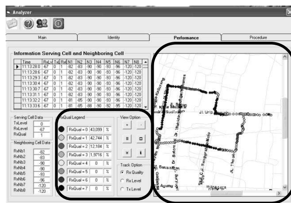
Gambar 11. Analyzer pada Saat Melakukan Tracking Performance untuk Rx Quality
