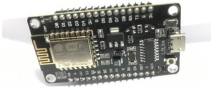
Gambar 4. NodeMCU ESP8266 V3
