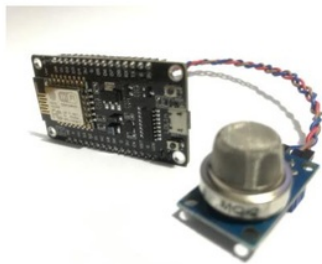
Gambar 5. nodeMCU ESP8266 yang disambungkan dengan sensor MQ-2
