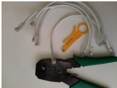
Gambar 1 Kabel LAN yang sudah di crimping
