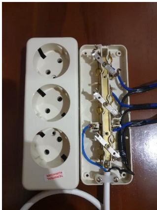
Gambar 13. Stop kontak tampak dalam
