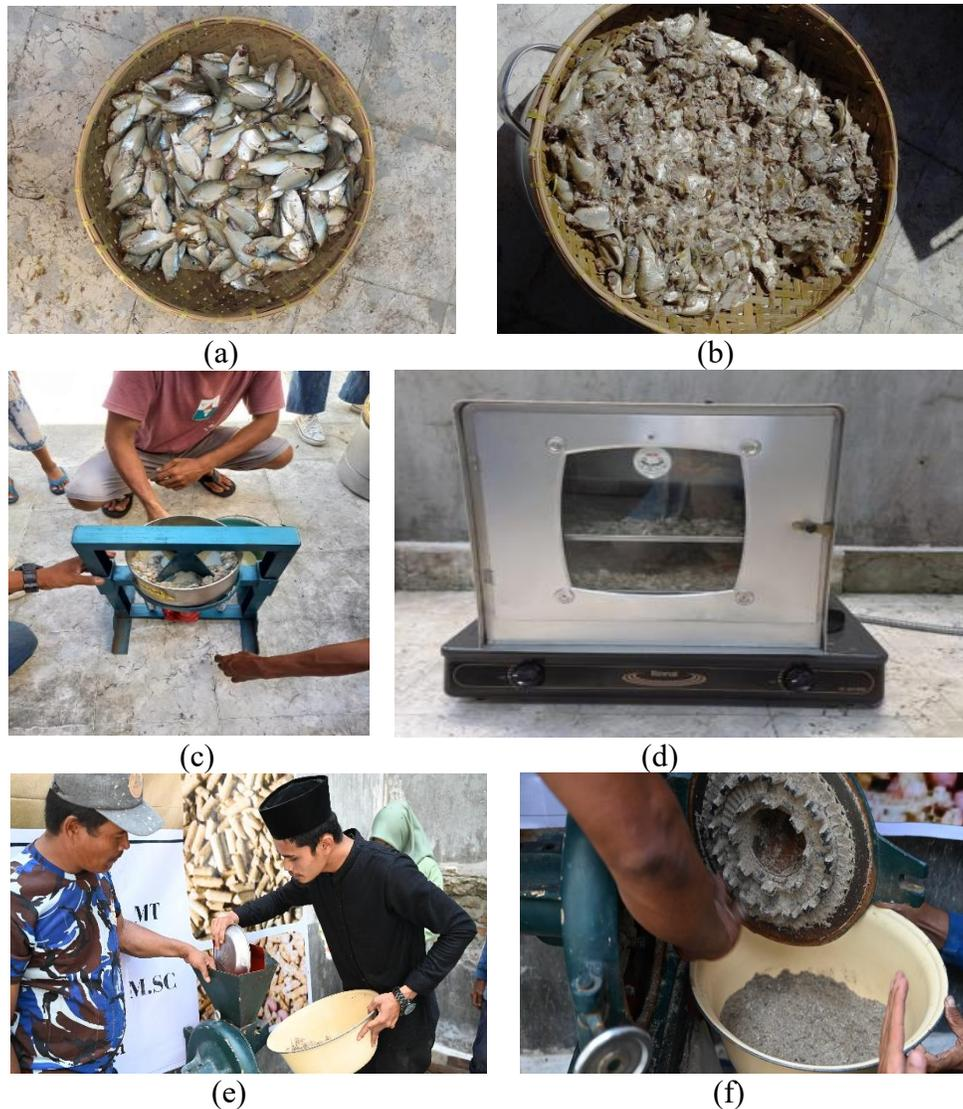
**Gambar 3.** (a) Ikan segar (b) Ikan setelah proses perebusan (c) Proses pengepresan ikan (d) Proses pengeringan ikan pada oven (e) Proses penggilingan ikan (f) Tepung ikan yang dihasilkan
