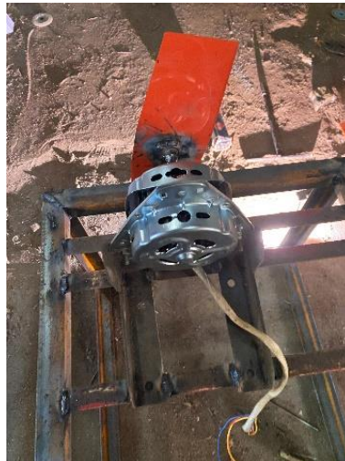
Gambar 5. Proses pembuatan mesin pencacah rumput
