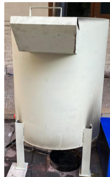
Gambar 2. Desain Tong Pembakaran, (a) Gambar Teknik, (b) Hasil Akhir Tong Pembakaran
