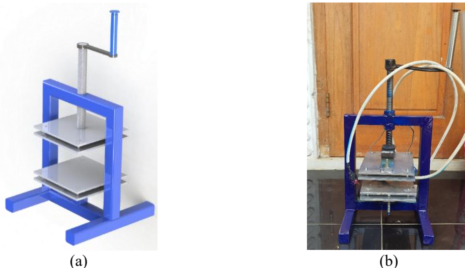
Gambar 3. Desain Alat Cetak dengan Metode Tekan Panas : (a) Desain Alat, dan (b) Alat
