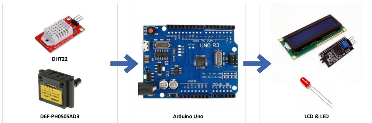
Gambar 4. Sistem elektronik yang digunakan untuk monitoring terdiri dari sensor DHT22 dan D6F-PH0505AD3, board mikrokontroler Arduino Uno, LED dan LCD yang dilengkapi unit komunikasi serial.
