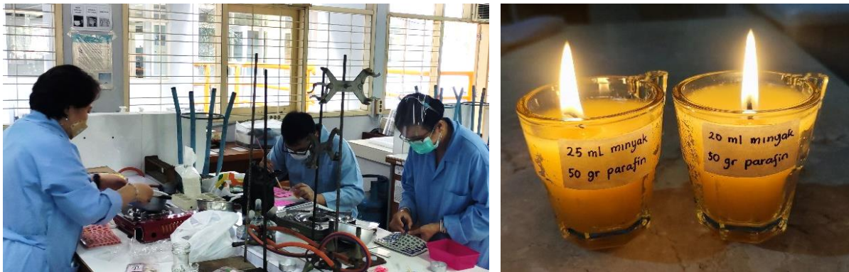
Gambar 4. Persiapan dan Uji Coba Pembuatan Lilin dari Minyak Jelantah (Sumber Gambar: Dokumen Pribadi)
