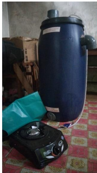
Gambar 5. Digester Biogas yang Telah Dirakit
