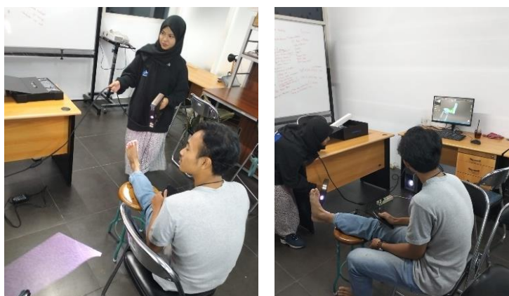
Gambar 5. Proses pengambilan gambar 3D kaki normal pengguna dengan menggunakan alat 3D Scanner .
