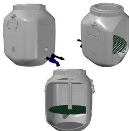
Gambar 3. Rancang Bangun Composter Tampak Depan, Belakang, dan Ruang Bagian Dalam
