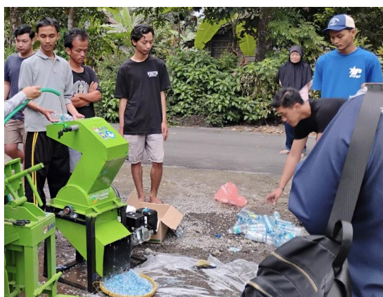
Gambar 4. Pelatihan Pencacah Plastik dengan Teknologi Tepat Guna
