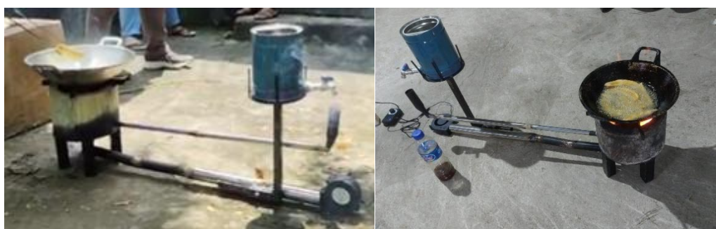
Gambar 3. Kompor Alternatif Berbahan Minyak Jelantah
