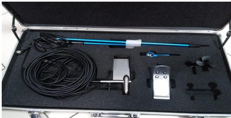
**Gambar 8** *Current Meter* digunakan untuk melakukan pengukuran debit air sungai
