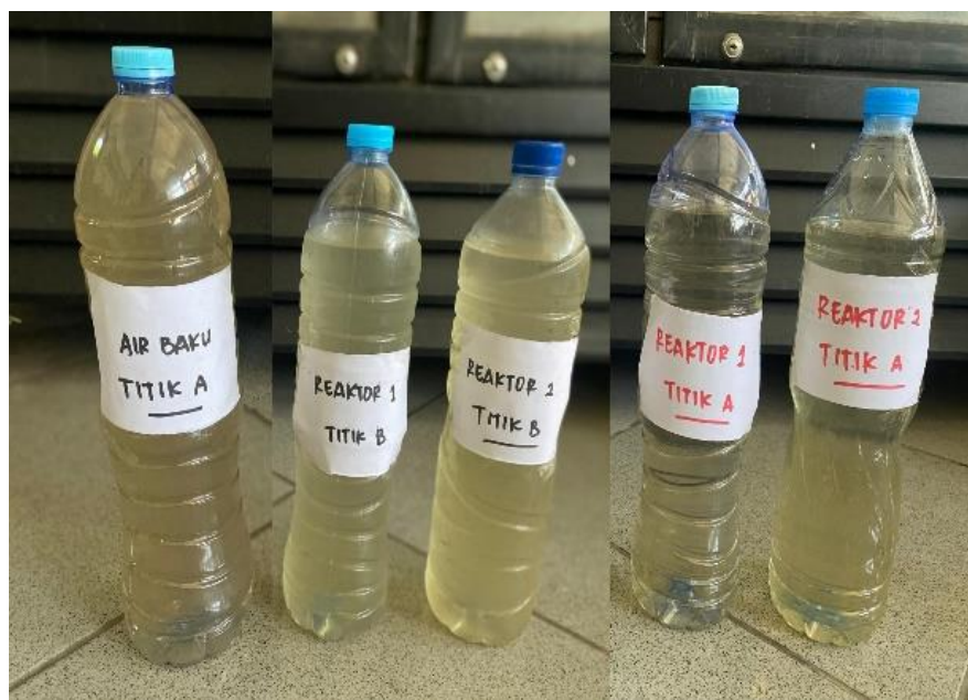
Gambar 9. Dokumentasi Air Embung Setelah Treatment dengan Filtrasi
