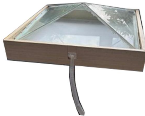
Gambar 2. Model inovasi rekayasa teknologi solar distillation untuk pemanenan air tawar dari air laut
