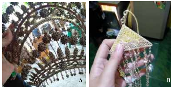
Gambar 2. (a) Logam sebelum proses electroplating, (b) perhiasan yang sudah dilapisi perak
