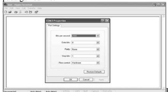
Gambar 10. Pengaturan baudrate pada hyperterminal
