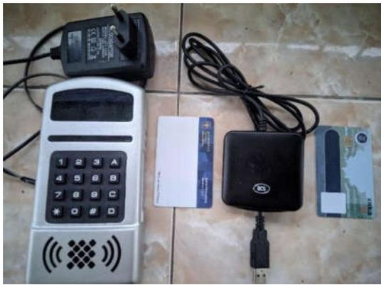
Gambar 4. Kebutuhan perangkat keras, dari kiri ke kanan: RFID-reader, RFID-tag (smartcard), kartu master editor, dan kartu master.
