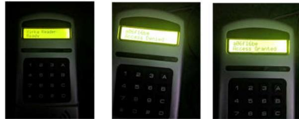
Gambar 18. Validasi Pengguna Melalui RFID Reader
