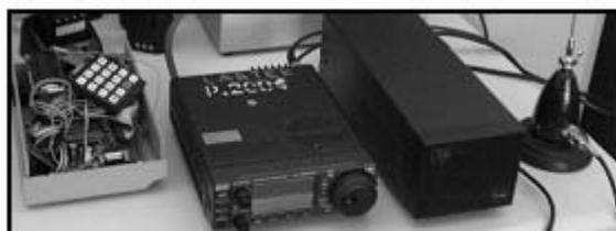
Gambar 11. Koneksi SMCD pengirim dengan Radio Transmitter
