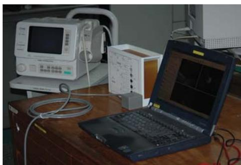
**Gambar 1.** Sistem berbasis komputer untuk kalibrasi, akuisisi, pemrosesan, rekonstruksi, dan visualisasi data USG 3-dimensi
