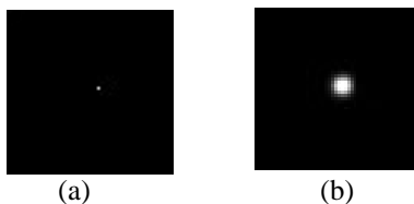
Gambar 2. Point Spread Spectrum pada citra bintang yang ditangkap oleh teleskop. Penjelasan gambar: (a) Citra bintang seharusnya, (b) citra bintang yang diamati akibat distorsi oleh PSF . [6]
