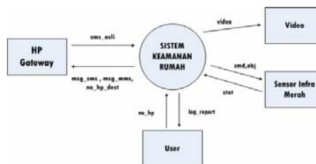
Gambar 2. Diagram Konteks Sistem Keamanan Rumah Sekunder
