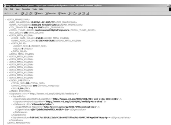
Gambar 16. Transkrip XML Digital Signature dengan DSAwithSHA1 type Enveloped
