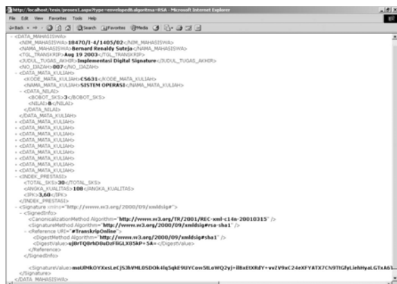
Gambar 18. Transkrip XML Digital Signature dengan RSAwithSHA1 Type Enveloped
