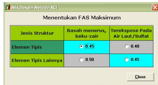
Gambar 9. Penetapan nilai FAS maksimum pada metode ACI
