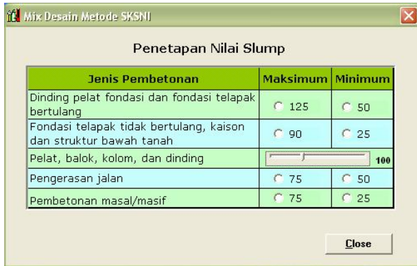
Gambar 4. Penetapan nilai Slump berdasarkan jenis pembetonan
