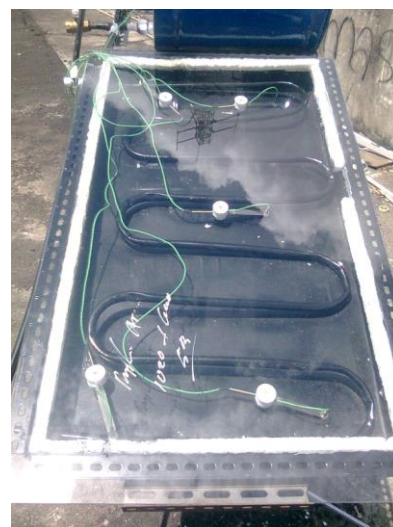
Gambar 3. Pengukuran temperatur kolektor surya dengan penutup kaca transparant dengan menggunakan 6 probe thermocouple .
