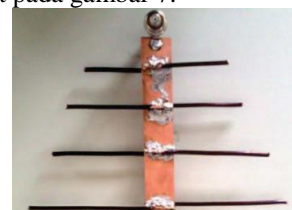
Gambar 6. Antena LPDA 4-elemen yang dibuat oleh nazar [4]
