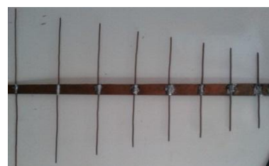
Gambar 7. Antena LPDA 8-elemen hasil implementasi
