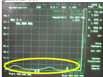
Gambar 10. Hasil VSWR antenna LPDA pada layar Network Analyzer
