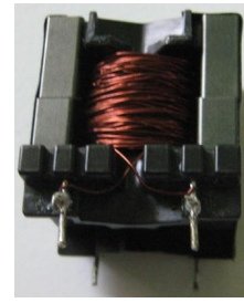
Gbr. 4. Transformator frekuensi tinggi yang telah dibuat
