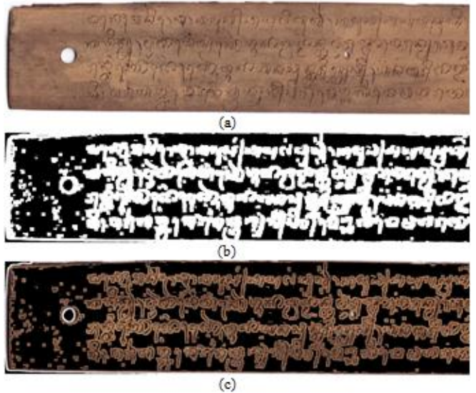
Gambar 7. Hasil Uji Citra 3 (a) Citra Asli IMG8.bmp RGB 24 bit (b) Citra Peta Lacunarity Biner 1 bit (c) Citra Hasil Segmentasi dengan Masking RGB 24 bit
