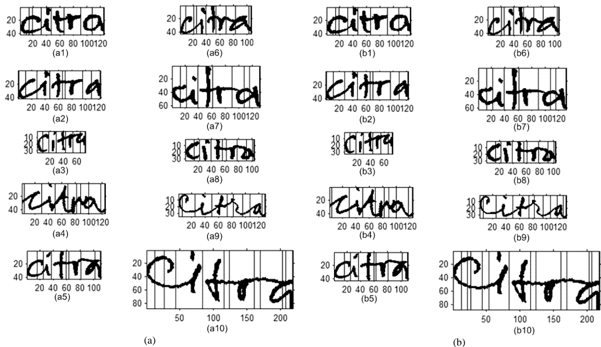
Gambar 8. Hasil-Hasil Segmentasi untuk Beragam Penulisan Kata “citra”; (a) Menggunakan Jendela Blackman 12 Titik dengan Nilai \alpha=0,12 ; (b) Menggunakan Tapis Gaussian 16 Titik dengan Deviasi Standar 4 [6]. (Catatan: Sumbu Tegak dan Horizontal Dinyatakan dalam Piksel)
