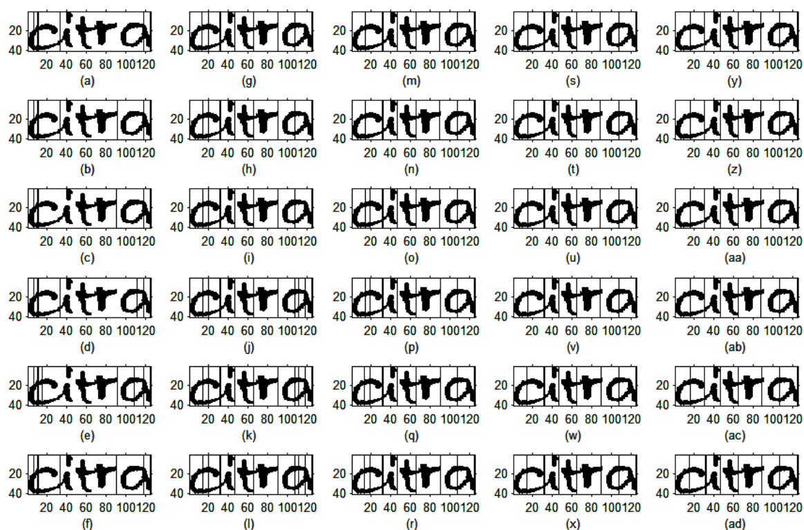
Gambar 7. Hasil Segmentasi untuk Berbagai Ukuran Jendela Blackman ; (a) – (f) Lebar Jendela 4 Titik dengan Nilai \alpha Masing-Masing Adalah 0, 0,04 , 0,08 , 0,12 , 0,16 dan 0,20; (g) – (l) Lebar Jendela 8 Titik dengan Nilai \alpha Masing-Masing Adalah 0, 0,04 , 0,08 , 0,12 , 0,16 dan 0,20; (m) – (r) Lebar Jendela 12 Titik dengan Nilai \alpha Masing-Masing Adalah 0, 0,04 , 0,08 , 0,12 , 0,16 dan 0,20; (s) – (x) Lebar Jendela 16 Titik dengan Nilai \alpha Masing-Masing Adalah 0, 0,04 , 0,08 , 0,12 , 0,16 dan 0,20; (y) – (ad) Lebar Jendela 20 Titik dengan Nilai \alpha Masing-Masing Adalah 0, 0,04 , 0,08 , 0,12 , 0,16 dan 0,20. (Catatan: Sumbu Tegak dan Horizontal Dinyatakan dalam Piksel)
