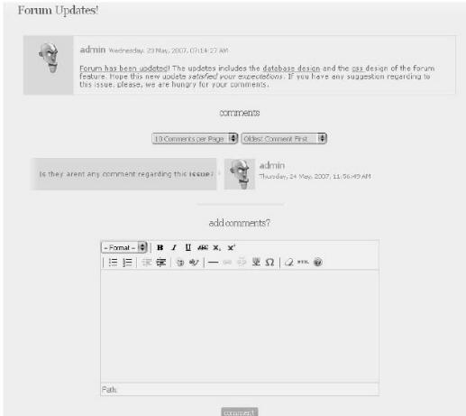
Gambar diatas menggambarkan perancangan user interface isi forum mata kuliah dari aplikasi e-Learning yang akan dikembangkan. Text box comment digunakan untuk meng-input-kan data forum post. Tombol save memungkinkan pengguna untuk menyimpan data forum post yang bersangkutan ke dalam database.
