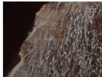
Gambar 12. Struktur *Adiabatic Shear Band* Pada Sampel U12 Susunan U12-A12
