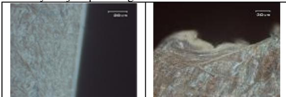
Gambar 10. Struktur Adiabatic Shear Band Pada Sampel A12 Susunan A12-U12
