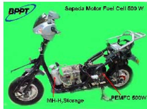
Gambar 5. Prototipe sepeda motor fuel cell dengan kapasitas 500 W PEMFC [6].
