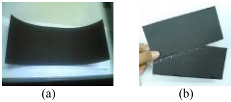
Gambar 2. Elektroda dan MEA dengan menggunakan Nafion 212, luas 100 cm 2 .
