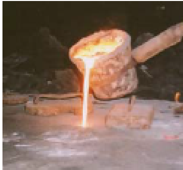
Gambar 5. Pemanguan logam cair ke dalam cetakan pasir.
