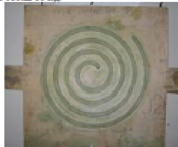
Gambar 3. Pola untuk pengujian sifat mampu alir logam cair.
