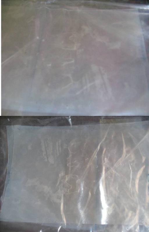
Gambar 3. Film kemasan dari pati tropis-PLA-khitosan (98:1:1 %) -plasticizer 1 %
