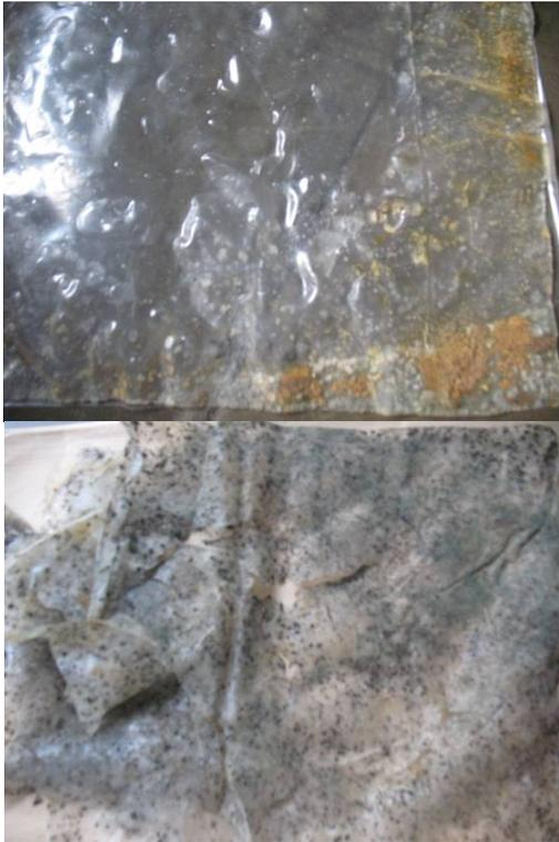
Gambar 1. Film kemasan dari pati tropis-khitosan (95:5 %)-plasticizer 2,5 %
