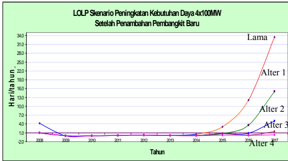
Gambar 9. Nilai indeks LOLP skenario 2 yang telah ditambah dengan pembangkit baru
