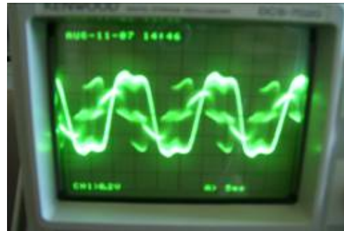
Gambar 14 Bentuk setelah Trafo
