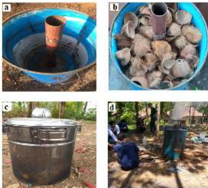
Gambar 3. Proses pengisian dan pirolisis tempurung kelapa kedalam reactor
