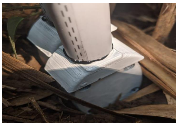
Gambar 13 : conduit pada sensor
