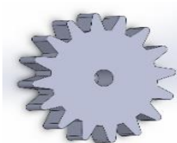
Gambar 8. Gear penggerak untuk motor stepper
