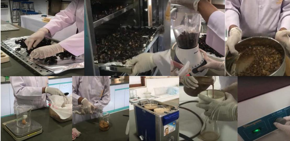
**Gambar 4:** Proses ekstraksi buah lerak
