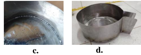
Gambar 16. (a) Proses pengelasan wadah penampung; (b) hasil pengelasan wadah penampung; (c) Hasil perbaikan karat las wadah penampung; (d) bentuk wadah penampung
