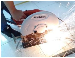
Gambar 11. Proses pemotongan plat untuk rangka
