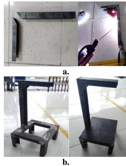
Gambar 13. (a) Proses pengelasan rangka tiang; (b) Pembentukan rangka utuh
