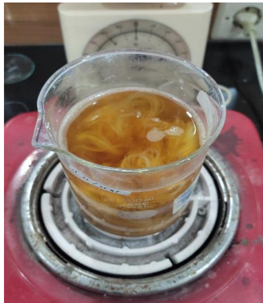
Gambar 1. Proses Degumming Serat Daun Nanas dengan Metode Alkalisasi NaOH
