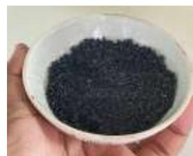
**Gambar 4.** Adsorben dari cangkang kelapa sawit setelah dikarbonisasi
