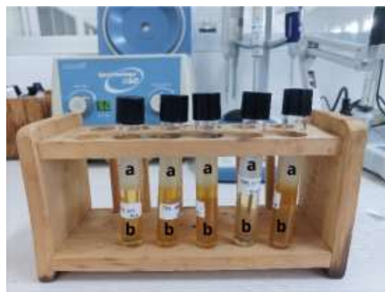
Gambar 5. Lapisan atas (a) berupa fase organik yang mengandung metabolit THC yaitu THC-COOH dan lapisan bawah (b) berupa urin.
