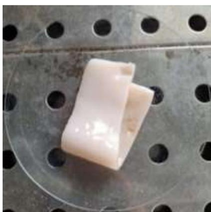
**Gambar 6.** BC *nata de coco* setelah proses reduksi hidrotermal (HBC)
