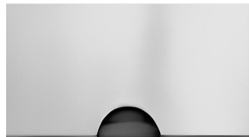
Gambar 6. Citra hasil proses pembersihan dari noise dari gambar asli yang terlihat pada Gambar 3 (Gambar hasil pembersihan noise ini nampak bersih dengan antar-muka fluida yang jelas batas-batasnya)
