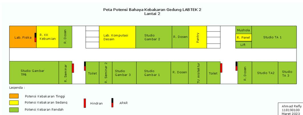
Gambar 7. Usulan Perbaikan Peta Potensi Kebakaran Lantai 2
