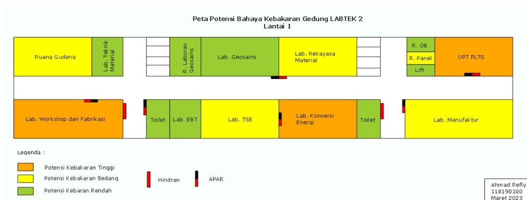
Gambar 6. Usulan Perbaikan Peta Potensi Kebakaran Lantai 1
