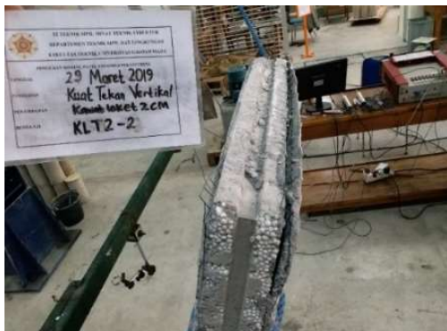
Gambar 15. Kerusakan slippage pada bagian atas KLT-2, 2
