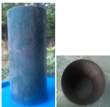
Gambar 2. Ring Infiltrometer berdiameter 11 cm dan tinggi 25 cm
